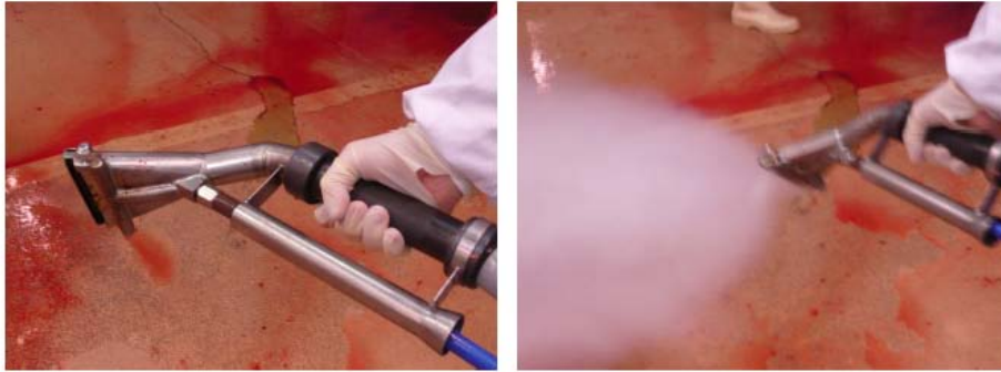
Illustration 5 : Détails de la tête de nettoyage
