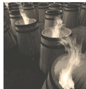
**Figure 3 : Brûlage du bois par brasero pour la fabrication de fût de chêne (chauffe < 230 °C) [à gauche, site Internet de la tonnellerie Dargaud et Jaegle ; à droite, site Internet de la tonnellerie Demptos]**
