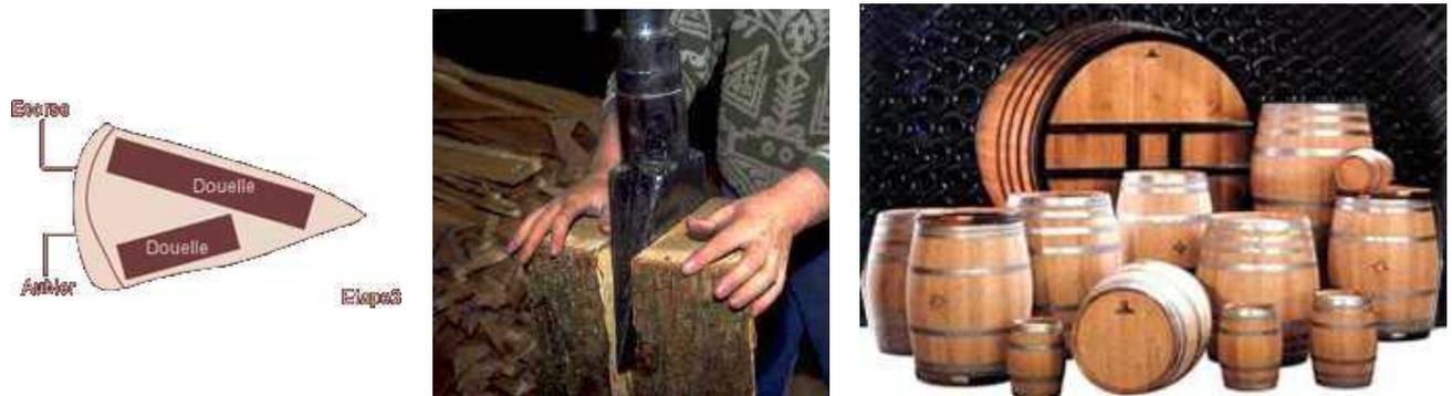
**Figure 2 : Fabrication des douelles pour fûts de chêne (à gauche et au centre, [site Internet de la tonnellerie Dargaud et Jaegle]) et différents types de contenants en bois pour le vins et les boissons alcoolisées (à droite, [site Internet de la tonnellerie Radoux ])**
