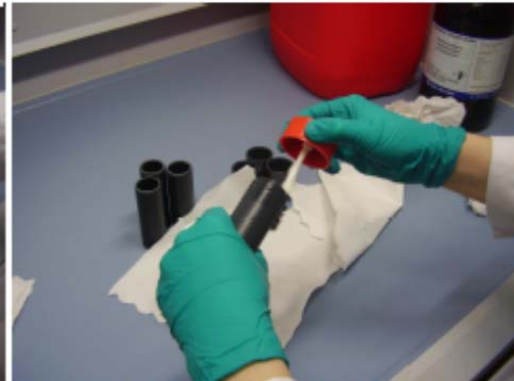
Figure 3 - Application de l'adhésif sur le tube
