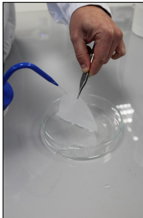
Figure 9 : le filtre à 20 \mu\text{m} est rincé sur sa face supérieure, à l'aide d'une pissette d'eau osmosée ou une micropipette, à raison de 10 à 15 mL. Le liquide de rinçage peut être réutilisé plusieurs fois si une micropipette à cône à usage unique est utilisée. Réaliser des rinçages du haut vers le bas, pour détacher, et faire « descendre » du filtre les particules capturées.
