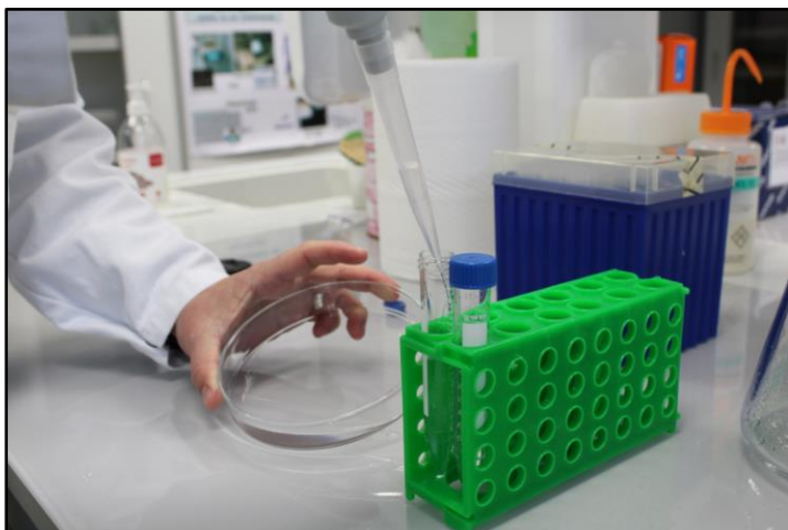
Figure 10 : Les 10 à 15 mL d'eau de rinçage du filtre à 20 \mu\text{m} sont récupérés et transférés dans un tube à centrifugation à fond conique. A chacune des trois prises d'essai correspondra un tube.
