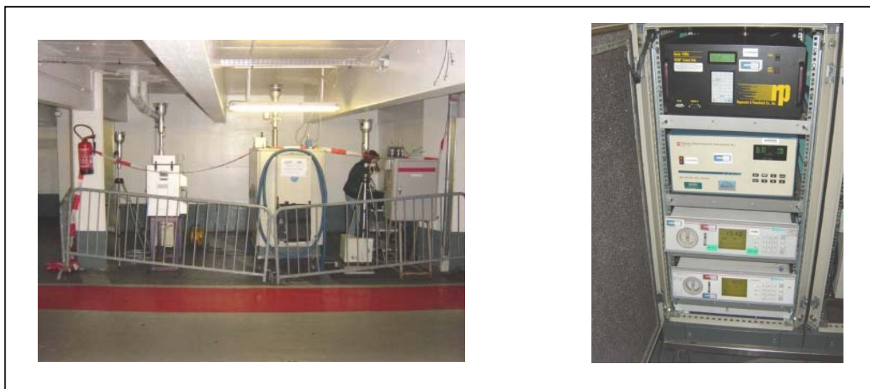
Figure 5 : Vue générale d'une des installations et d'analyseurs automatiques (PM 10 , NO x , CO, CO 2 ) [source : Afsset]
